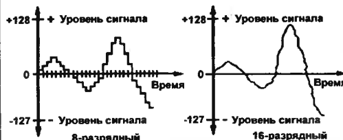
Рис. 2. Различия при 8- и 16-битном представлении сигнала.
